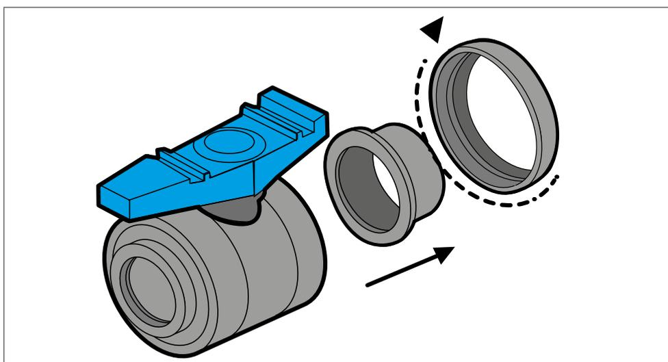
Démonter un des côtés de la vanne pour récupérer l'embout et la couronne
